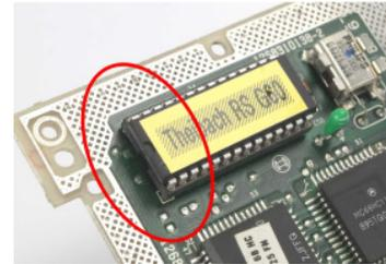
Nach Einbau des Chips, oder von Chip und Laderrad muss der Motor neu eingestellt werden. Zuerst muss die Zündung kontrolliert, ggf. eingestellt werden. Im 2. Schritt der CO-Gehalt.
